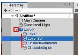
Vous constatez qu'ici le niveau est composé de quatre sous-objets. L'objet Level1 est le contour du niveau : la bordure empêchant la balle de tomber dans le vide. Parfois il n'y aura pas de contours. L'objet Level1.Sol est le sol du niveau : la surface sur laquelle la balle peut rouler. Pour vous faciliter le travail, j'ai volontairement séparé le contour du
